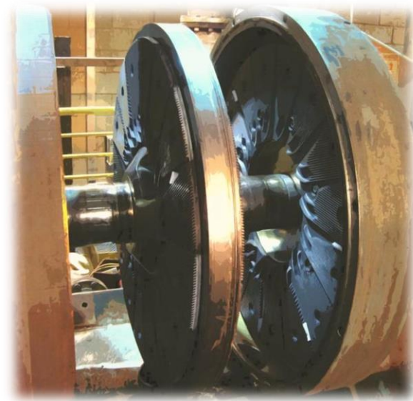
Elementos de refino de um refinador de discos duplos
