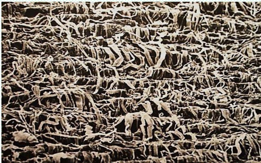
Superfícies crepadas e gofradas de papéis tissue obtidos de fibras celulósicas de eucalipto
