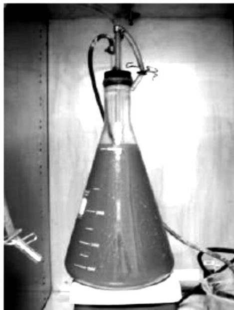
Ensaio BMP – “Biochemical Methane Potential” Fonte da figura: Moody e colaboradores, 2009
