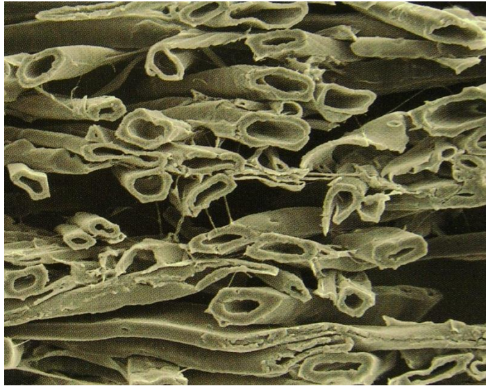
Fibras celulósicas de Acacia mangium (com paredes delgadas em relação ao seu diâmetro)
