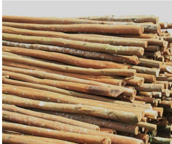
Escoras de bracatinga para construção civil Fonte da foto: http://pinhais.olx.com.br
