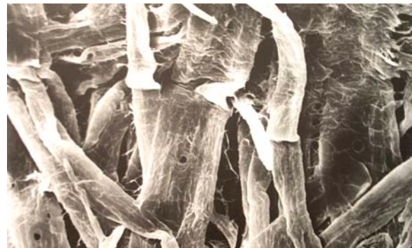
Superfícies de papéis "tissue" (estrutura frouxa para permitir absorção e maciez)
