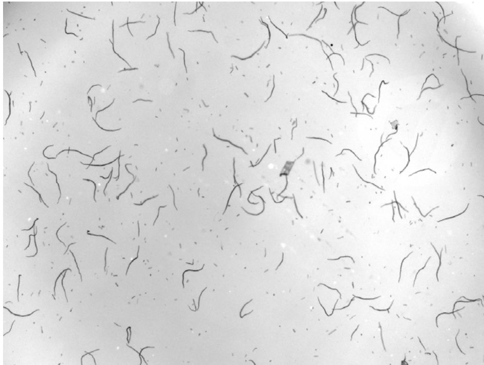
Finos e fragmentos de fibras em uma suspensão de fibras em baixa consistência Cortesia da foto: Techpap , CTP Grenoble & Regmed
