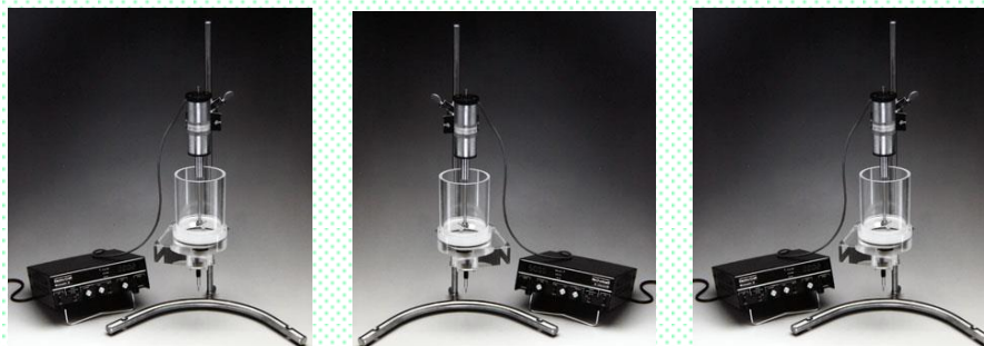
Britt jar tester para medição de teor de finos nas polpas e massas de "furnish"
