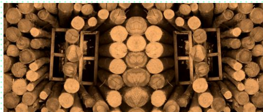
Gaiolas amostrais para acompanhamento do peso tal qual de toras referenciais com volumes conhecidos (densidade aparente tal qual e também densidade aparente anidra)
