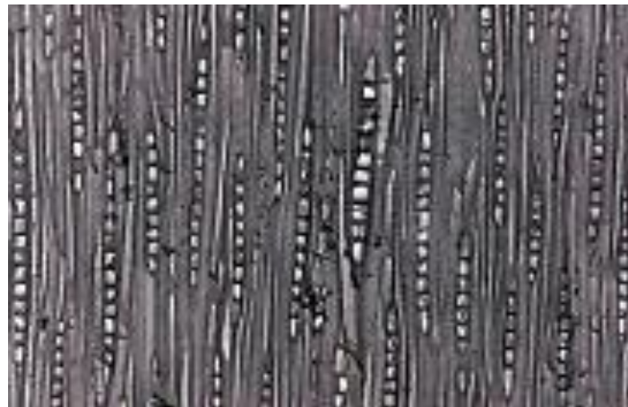
Madeira do Pinus Seções transversal e longitudinais (radial e axial)
