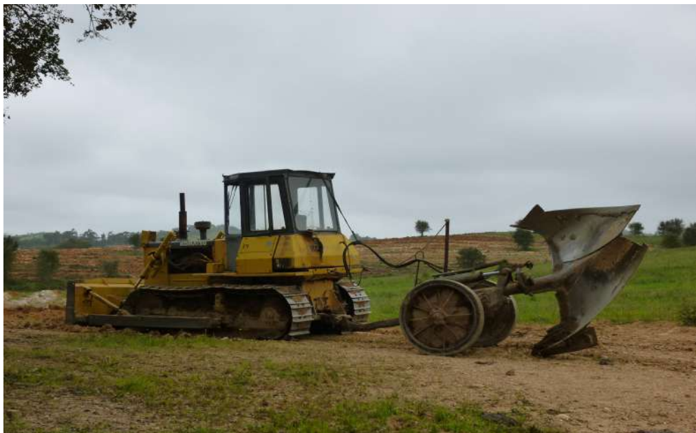
FIGURA 5.6 Trator de rastos com charrua rebocada com aiveca a 180° para construção de vala e cômoro.
