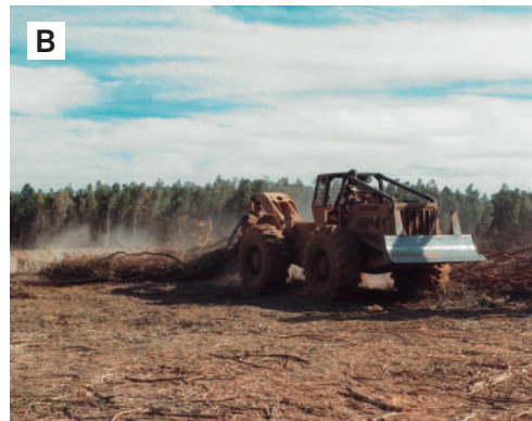
FIGURA 6.10 Trator rechegador equipado com pinça (A) ou garra hidráulica (B).
