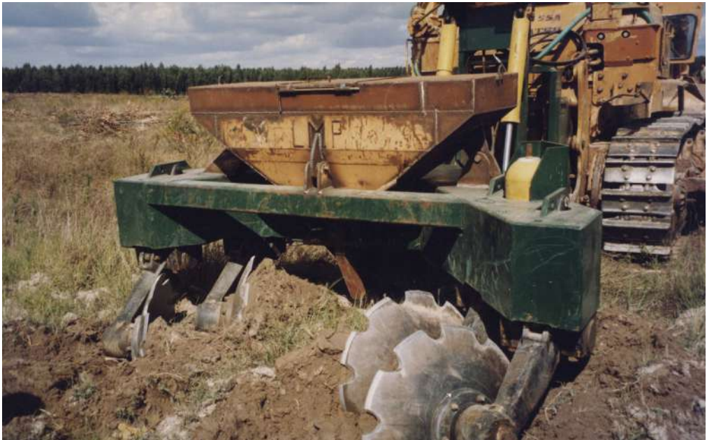
FIGURA 5.8 Equipamento de permite a operação múltipla de ripagem, amontoa e fertilização.
