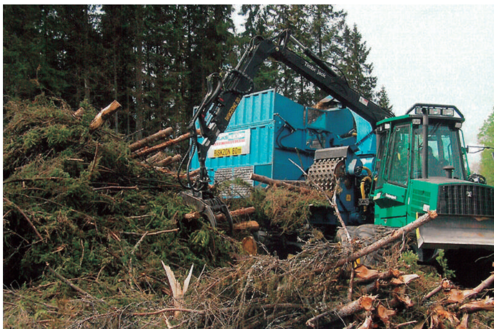
FIGURA 6.20 Trituração na mata com estilhaçadores móveis.
