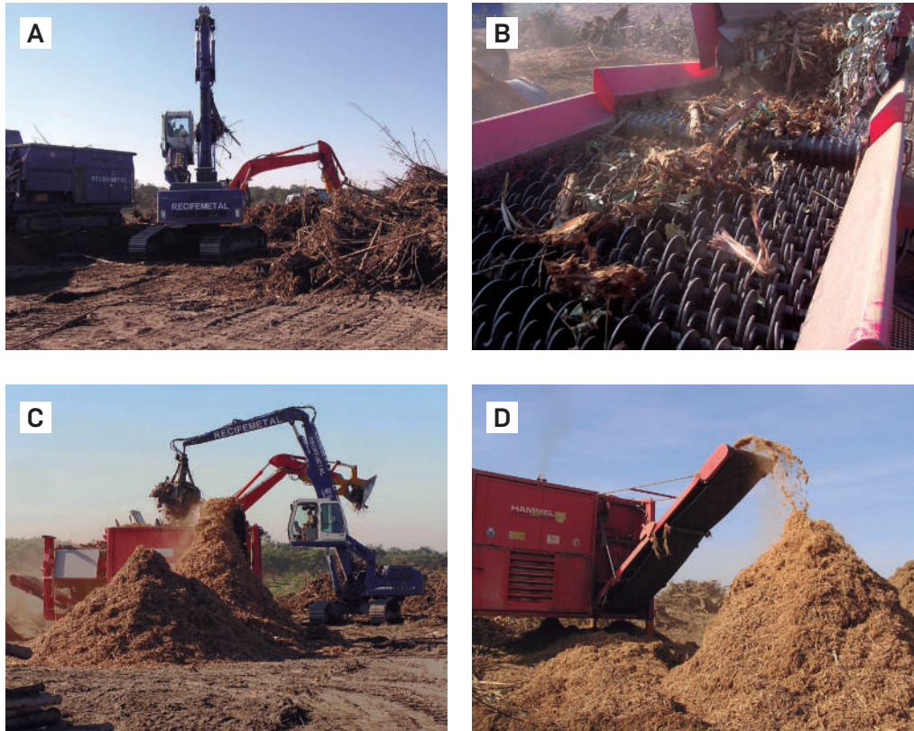
FIGURA 6.21 Pré-trituração de cepos (A); crivagem dos cavacos (B); visão geral do processo de produção de biomassa (C); produto final após trituração (D).
