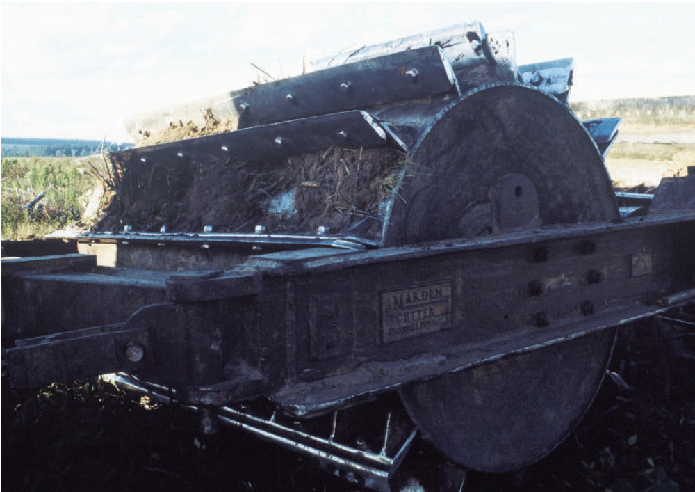
FIGURA 5.3 Rolo / Faca utilizado para incorporação dos resíduos de exploração florestal.
