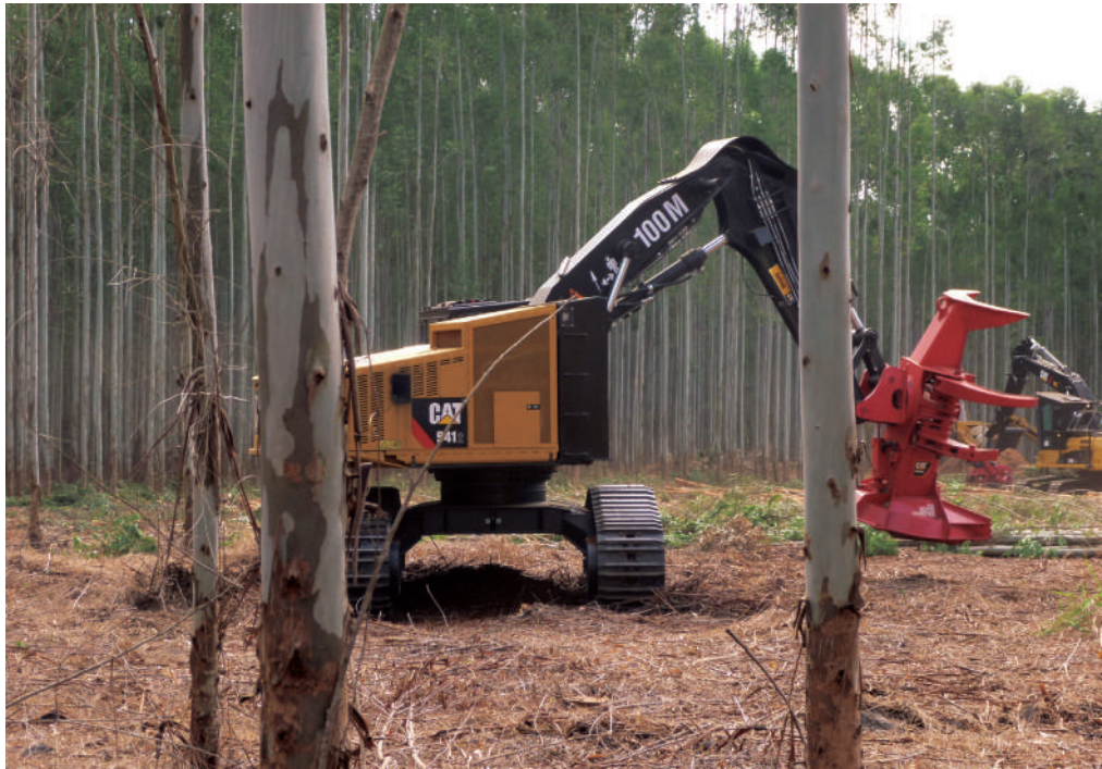
FIGURA 6.5 Cabeça de feller-buncher montada em "giratória" adaptada.
