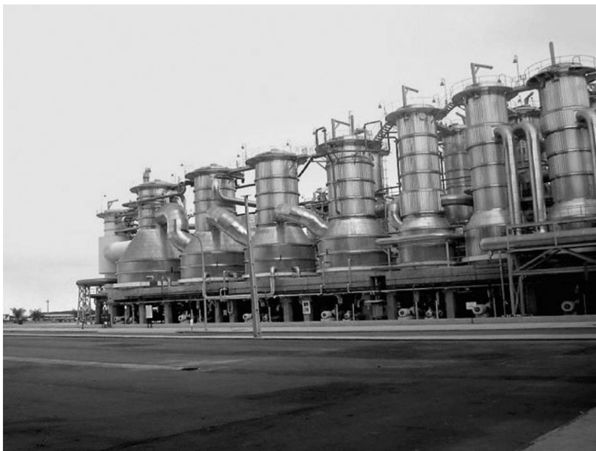
Sistema de evaporação do licor preto
