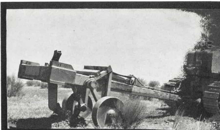
Fot. 79 — Tractor Internacional TD 20 com ripper — Fot. de Jorge Medeiros.
