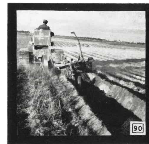
Fot. 87 — Ripagem feita por tractor D 7 com 3 dentes, em solos delgados de xisto no Baldio da Cabeça Gorda (Beja) para plantação de eucaliptos — Fot. do autor.
