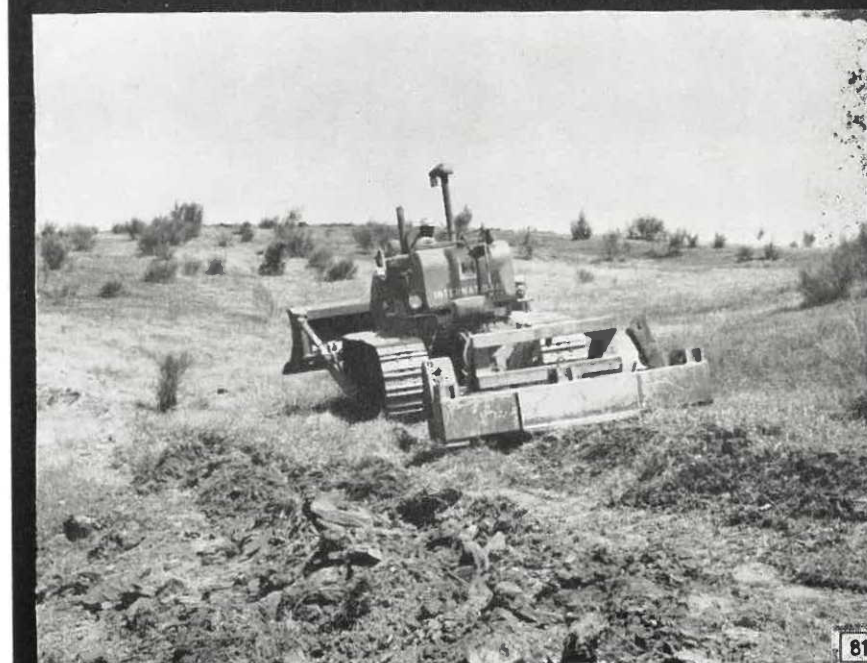
Fot. 81 — Ripagem com um dente, segundo as curvas de nível, apenas nas linhas de plantação, em solos esqueléticos de xisto — Fot. de Jorge Medeiros.
