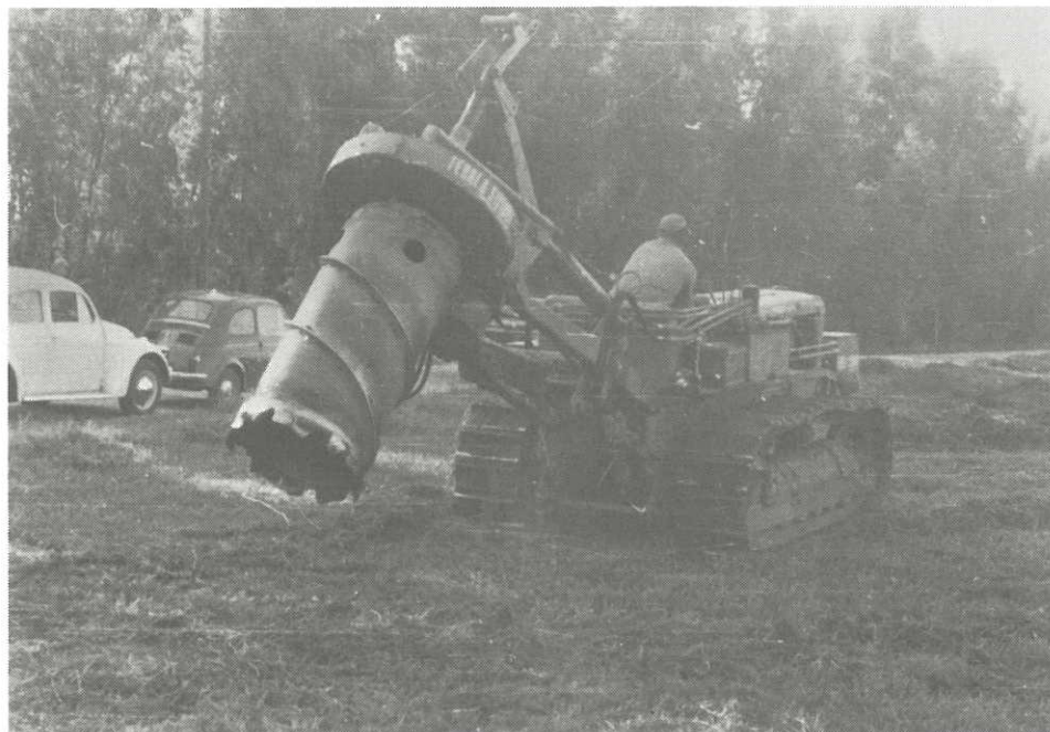
Fot. 69 — "Levi-ceppi" italiano, no arranque e remoção de toças de eucalipto, na bonifica de Macaresi.
