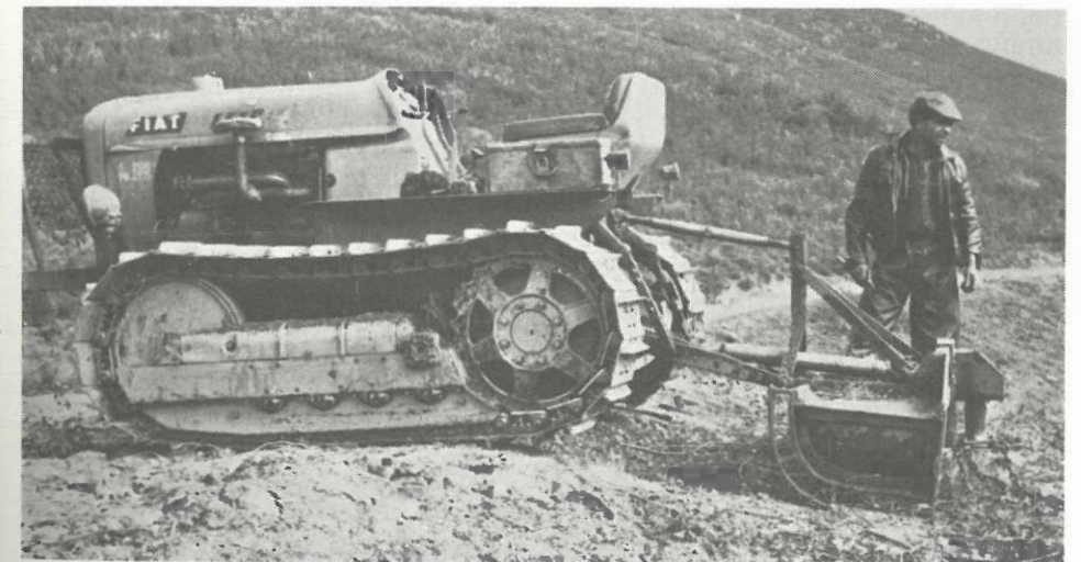
Fot. 68 — Tractor de montanha com corta mato de correntes, verificando-se já uma parte limpa de mato.
