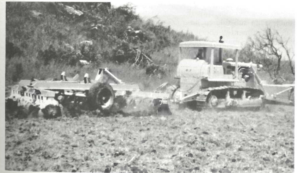
Fot. 72 — Lavoura com tractor muito potente, com grade Rome de 7800 kgs, na preparação do terreno para a plantação de eucaliptos em Angola.
