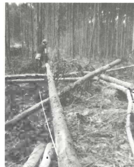
Fot. 114 — Desramação com motosserra e marcação simultânea, com fita, do comprimento dos toros.
