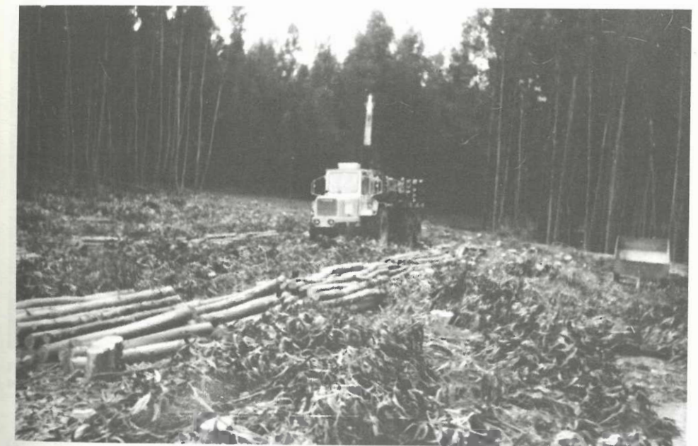
Fot. 122 — Forwarder rechegando madeira, Mata do Barrancão no concelho de Aljezur.
