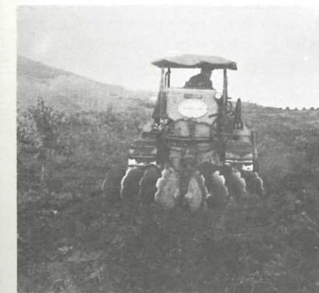
Fot. 95 — Tractor de lagarta com grade de discos acoplados, para efectuar a mobilização superficial do solo entre as valas de plantação.
