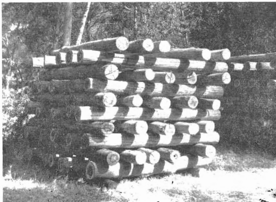
Parc à bois de la S.R.F. Rabat Poteaux de Eucalyptus grandis disposés en grille. Après 2 mois de dessiccation on peut considérer qu'il n'apparaîtra pas de nouvelles fentes et que celles qui ont déjà apparentes ne s'étendront pas.
