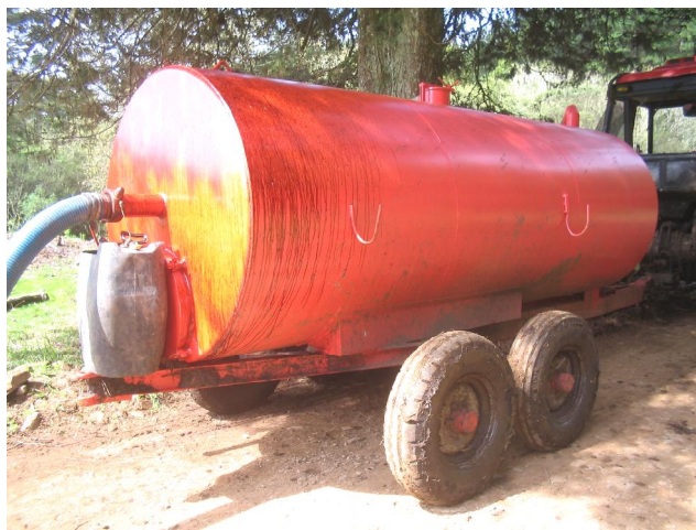
Máquina para aspersão de biofossolido líquido no solo em florestas de mais idade
