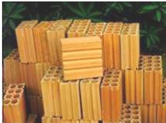
Tijolos contendo lodo de ETA's
