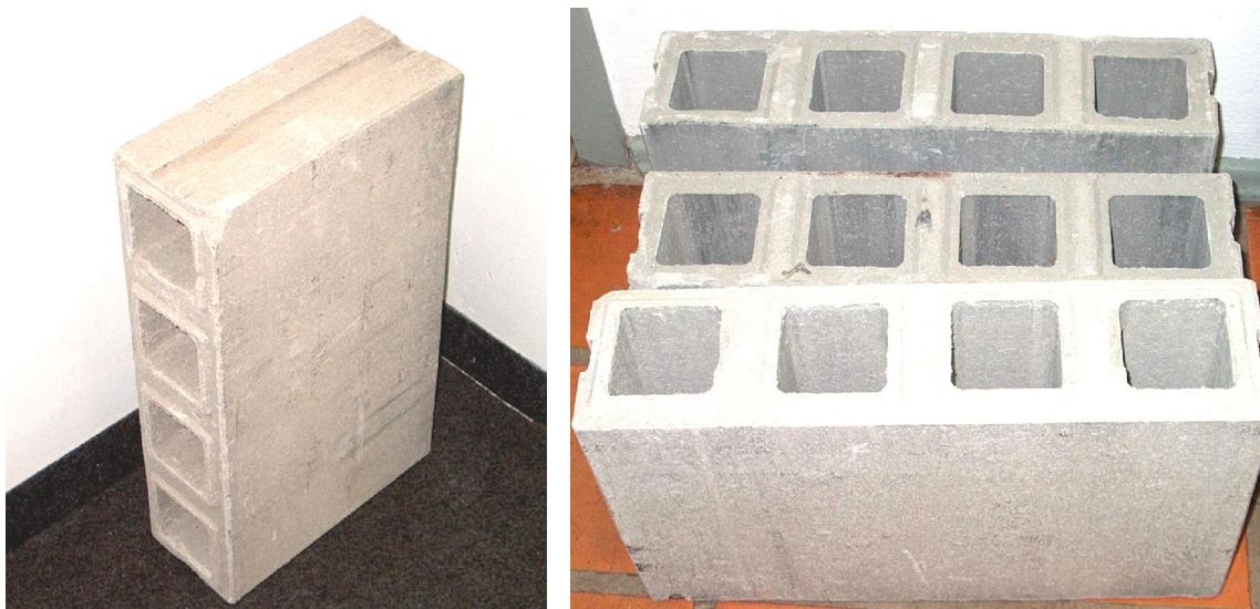
Blocos de cimento com alta carga de lodo de papel
