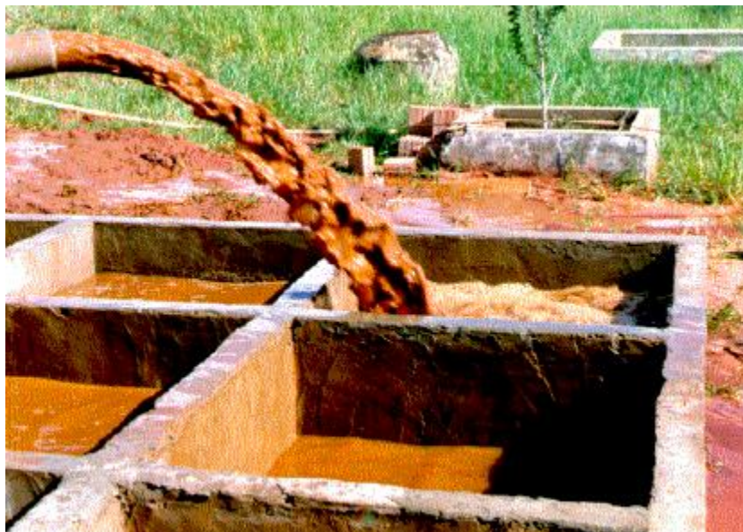
Lodo do tratamento de água a baixa consistência Fonte: Sabbag e Morita, 2003
