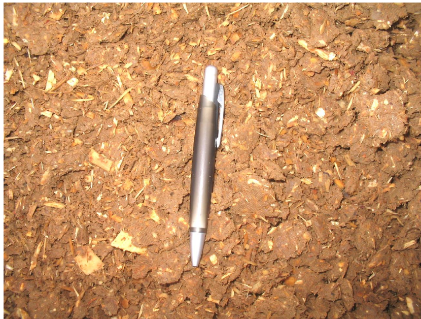
Lodo de tratamento de efluente misturado à serragem de madeira para melhorar sua qualidade como combustível
