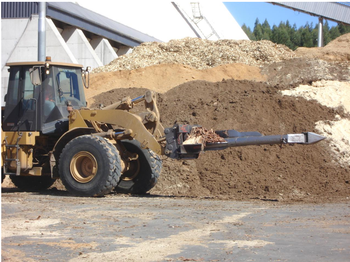
Lodos e biomassas em pilha de biocombustíveis para alimentação de caldeira de força
