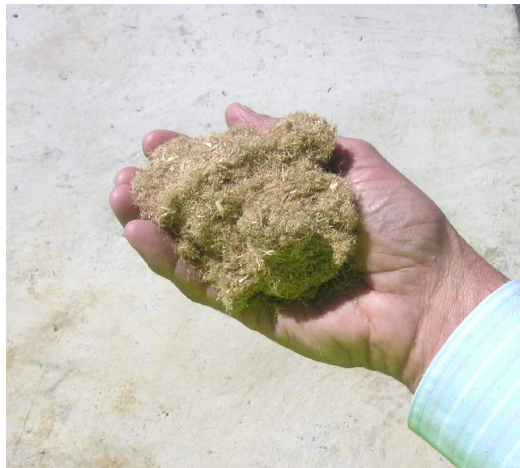
Pó de serragem para mistura ao lodo para facilitar desaguamento e prensagem dos lodos da ETE
