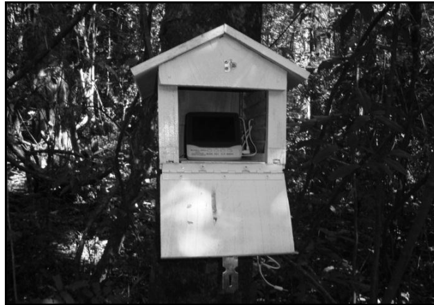
Figura 2. Termohigrômetro utilizado para o registro de temperatura e umidade relativa. Figure 2. Pocket Thermometer used to record temperature and relative humidity.
