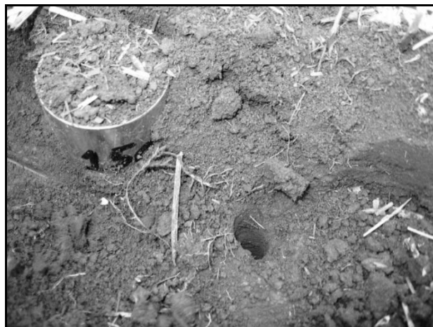
Figura 3. Coleta de solo através de anéis volumétricos para análise de densidade do solo e porosidade total do solo.
