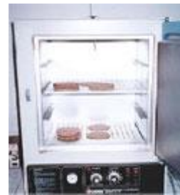
Equipo: “analizador de humedad”. Figura 14 – FUENTES: (36)
