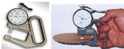
Equipo: medidor de espesor.
