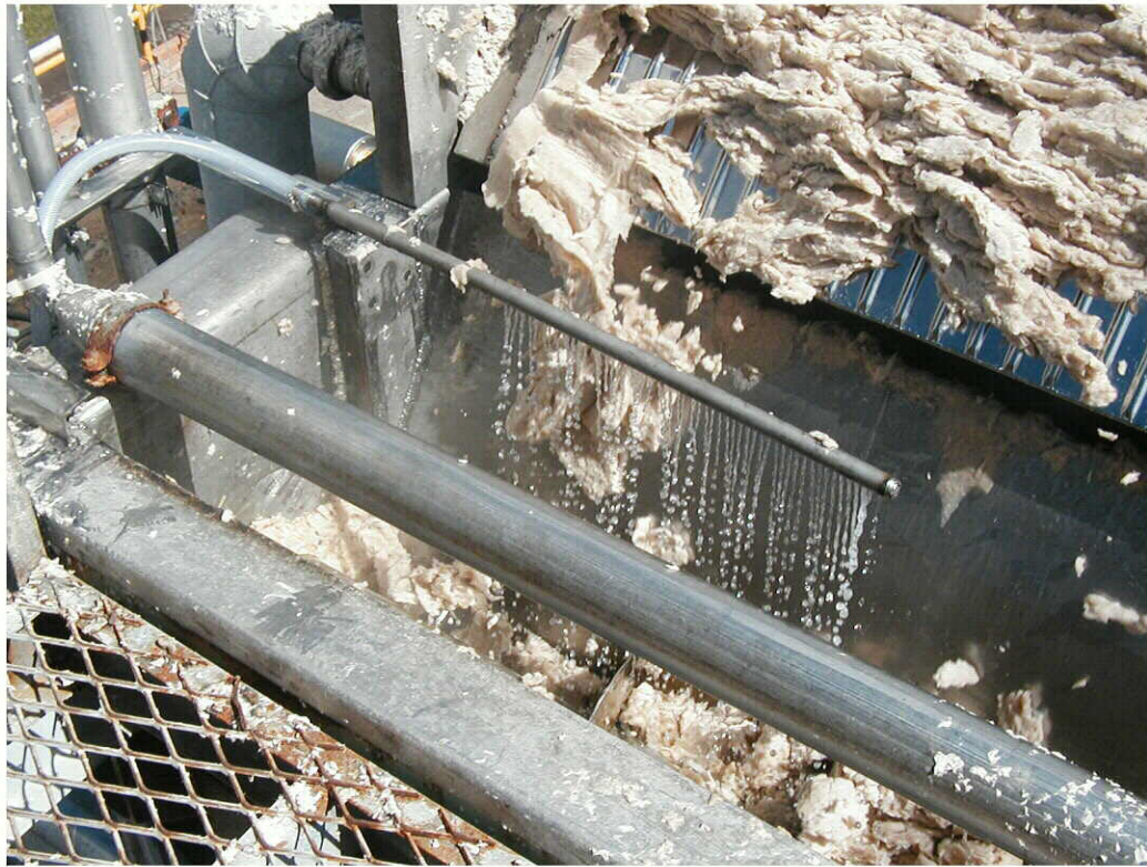
FIGURA 2: Dosagem de peróxido de hidrogênio em chuva no MCOB.
