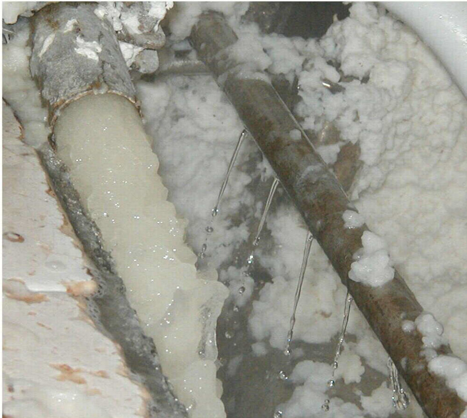
FIGURA 4: Dosagem de peróxido de hidrogênio em chuveiro no branqueamento.
