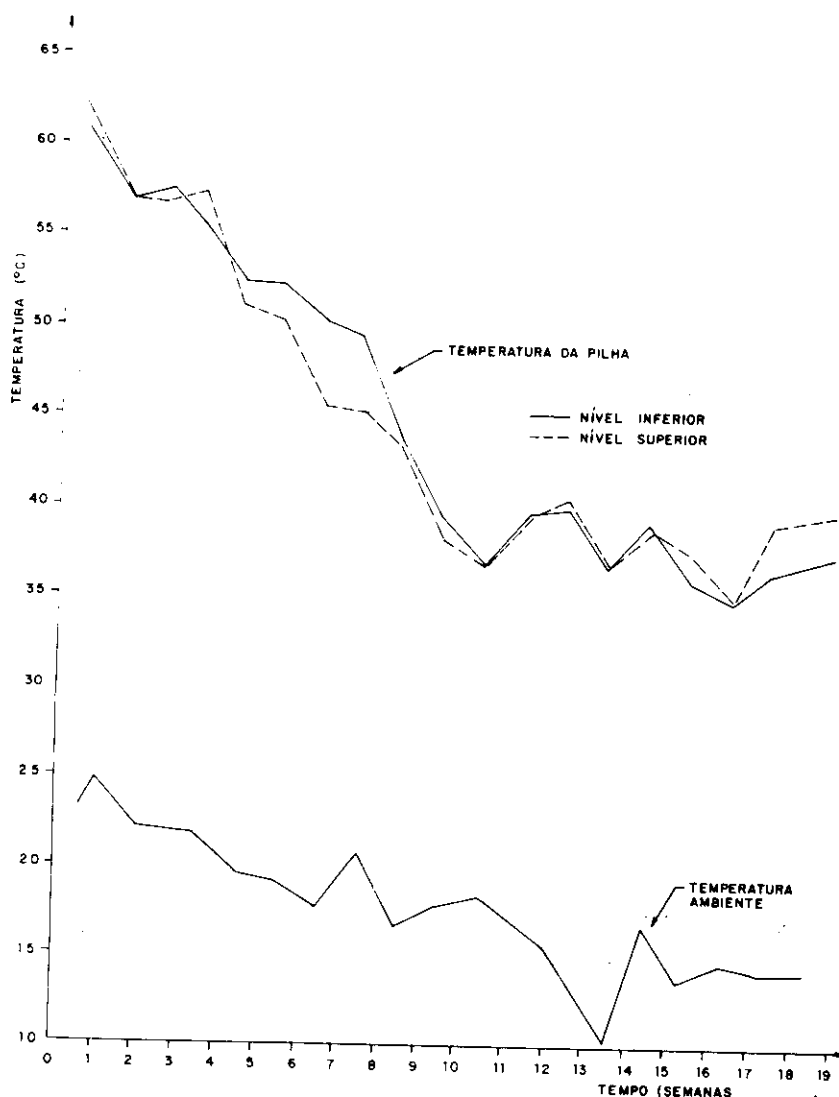
Figura 2. - Variação da temperatura ambiente e no interior da pilha em função do tempo de estocagem.
