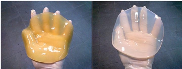
Figura 2. Lámina de CB antes (izda.) y después (dcha.) de su purificación con 1% NaOH.
