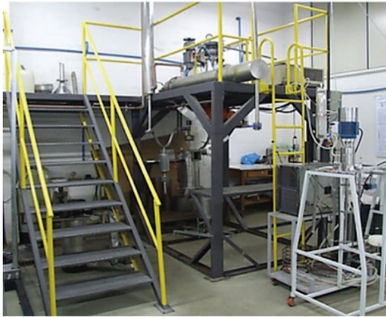
Figura 8. Imagem do reator de explosão a vapor instalado na Universidade Federal do Paraná.
