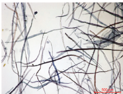
Figura 1 - Fotomicrografia das fibras de eucalipto, sem refinação – 100 x de aumento (Fioritti, 2014)
