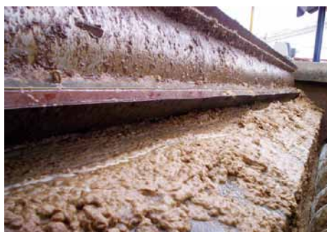
Figura 5: Equipo de barrido, lodo, y tornillo de conducción.
