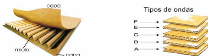
Figura 1: Estrutura das chapas de papelão ondulado.
