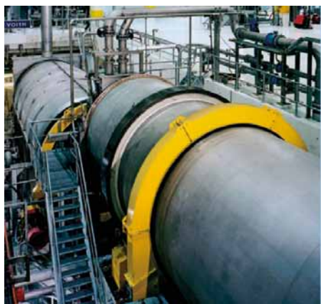
Figura 8: Fotografía y esquema de un púlper tambor de Voith (Voith Paper, 2011).
