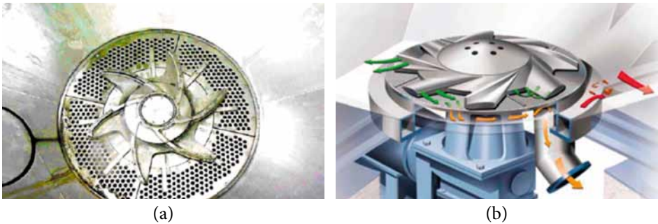
Figura 3: a) fotografía de una agitador para desintegrar a baja consistencia (Holik, 2000) y b) esquema de funcionamiento (Egan & Demler, 2004).
