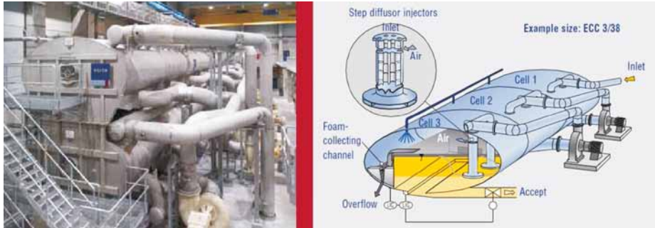
Figura 8: Fotografía y esquema de la celda de flotación EcoCell con LowEnergyFlotation™ (LEF) (Voith, 2011) http://www.voithpaper.de/product.php?pk=594 .
