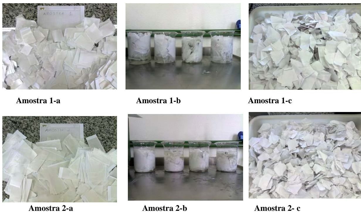
Figura 3: Estágios do tratamento: (a) antes do tratamento; (b) após 24 horas com Ac; (c) secas ao ar livre
