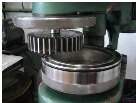
Figura 2: Detalhe do rotor e recipiente de refinação
