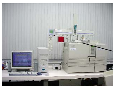
(a) Cromatógrafo gasoso acoplado ao espectrômetro de massas (GCMS-QP5050A-Shimadzu), com dispositivo de head-space (Combi-Paul - AOC5000-Shimadzu).
