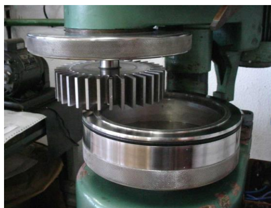
Figura 2: Detalhe do rotor e recipiente de refinação
