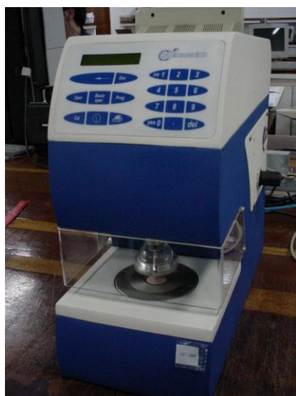
Figura 1 - Aparelho Mullen Tester utilizado no ensaio.
