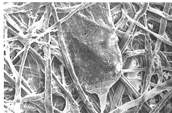
FIGURA II.14 - Elemento de vaso de Eucalyptus sp na superfície do papel (microscópio eletrônico de varredura)
