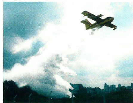
Depois de captar água nos rios, represas ou no mar, a aeronave anfíbia é capaz de lançar, em uma hora, de 14 a 184 mil litros de água.
