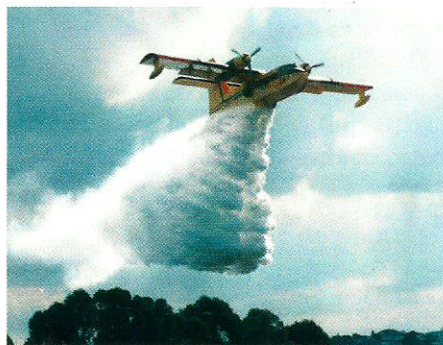
Depois de captar água nos rios, represas ou no mar, a aeronave anfíbia é capaz de lançar, em uma hora, de 14 a 184 mil litros de água.
