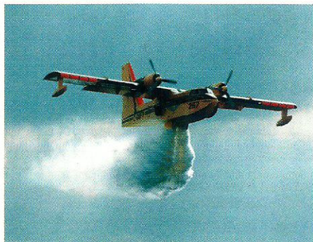
Depois de captar água nos rios, represas ou no mar, a aeronave anfíbia é capaz de lançar, em uma hora, de 14 a 184 mil litros de água.
