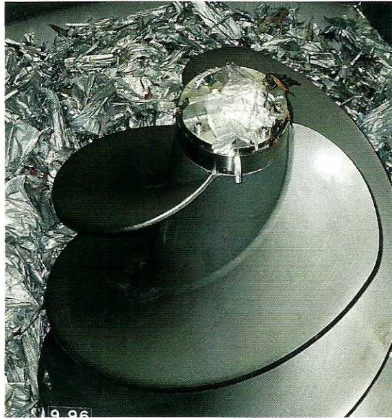
Máquina separa alumínio do polietileno e papel
