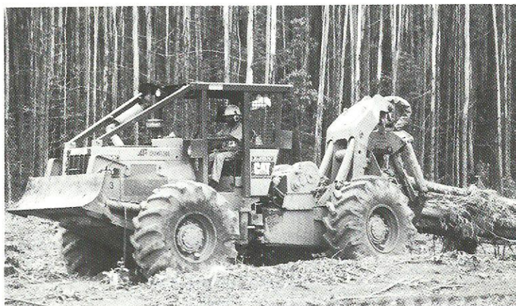
Equipamento Caterpillar que combina o trabalho de fellbancher, skidder e escavadeira hidráulica.
