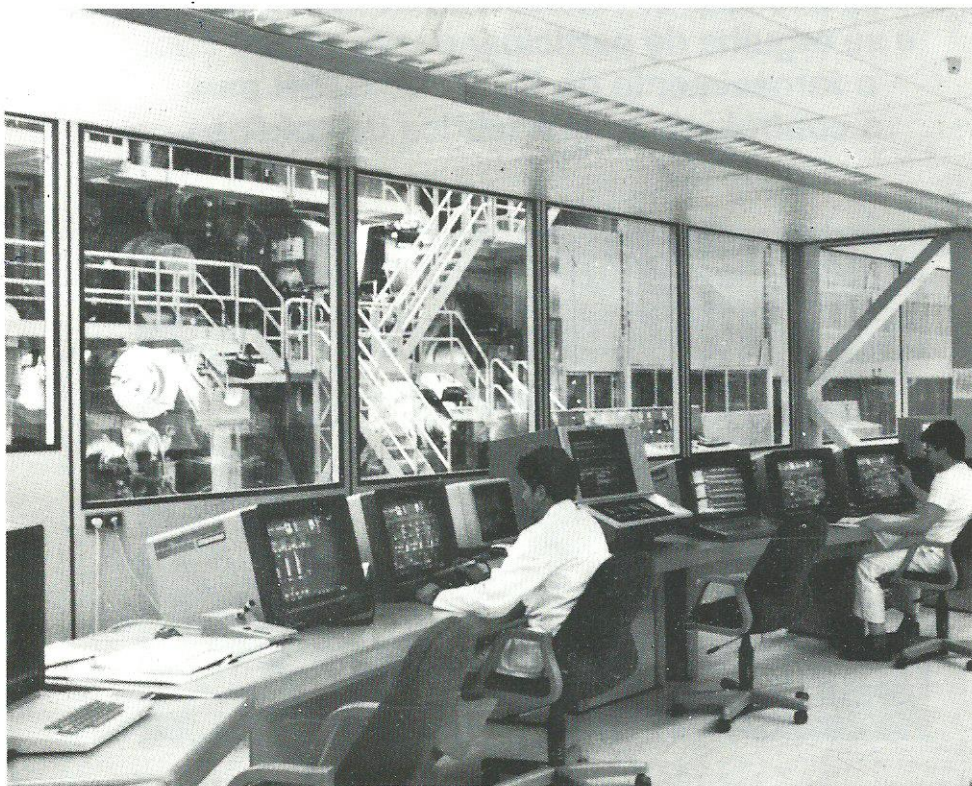
Controle com acionamento produzido pela Siemens para máquina de papel.
