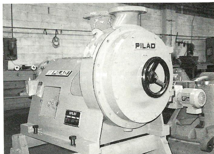
Despastilhador "tric-disc" de 20 polegadas; mais homogeneidade.
