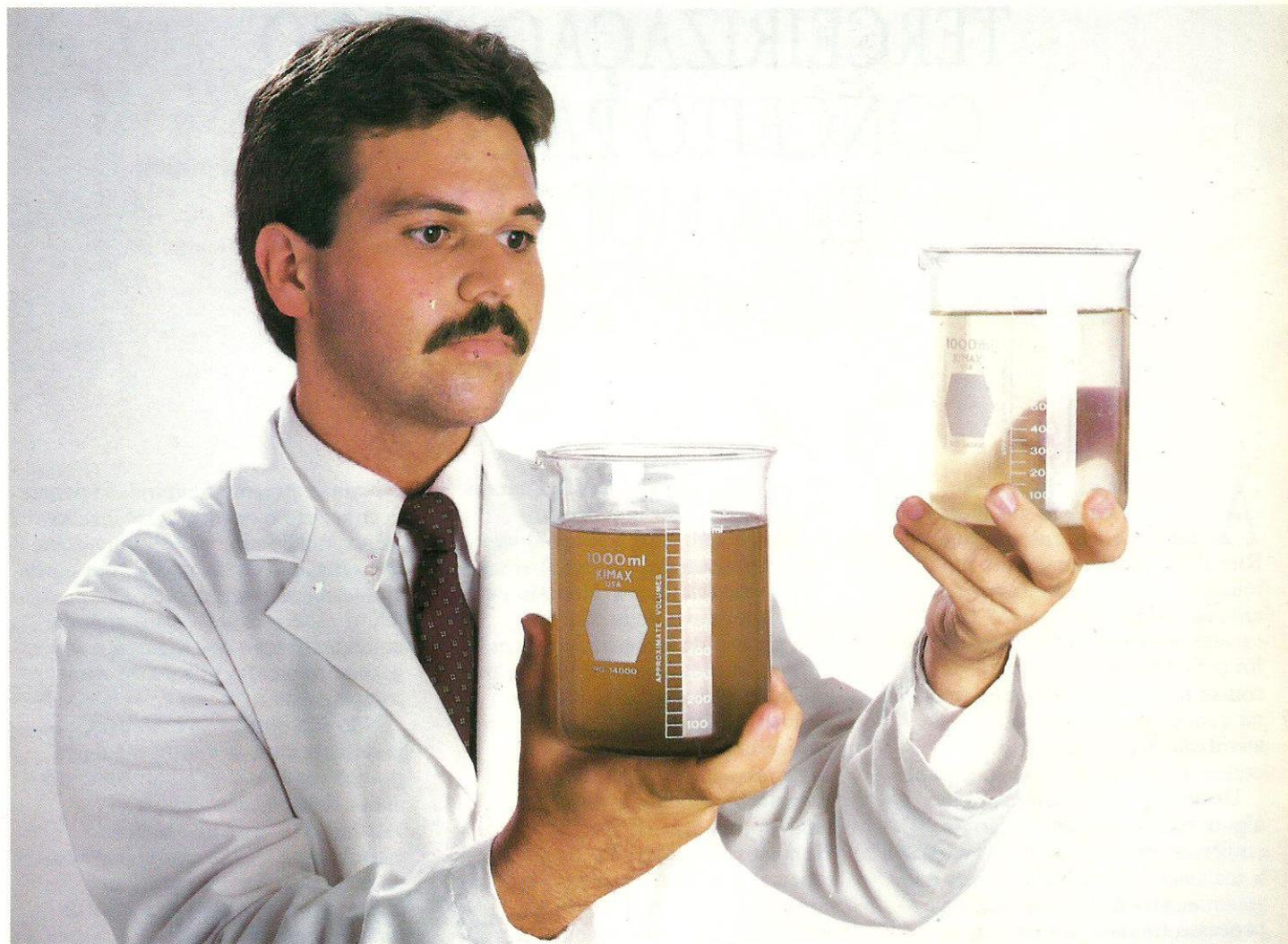
Na fotografia acima as amostras de água embaixo da tela foram retiradas durante um teste recente com o CATO<sup>®</sup> 3210 em papel kraft. Na análise da amostra à esquerda detectou-se finos e solúveis orgânicos, enquanto que a amostra à direita foi retirada quando esteve em uso na máquina o CATO<sup>®</sup> 3210 - uma nova geração de amidos anfóteros. Observe a mudança na coloração da água após adição do
