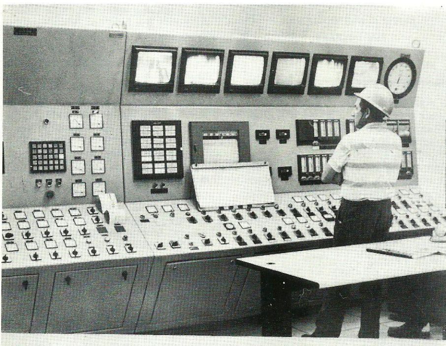
Sala de controle convencional: a tendência atual é substituí-la pelos sistemas digitais.
