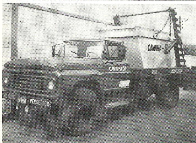
Poliguindaste modelo KPG-90/ 230-SHA-V3-SS, com caçamba estacionária.
