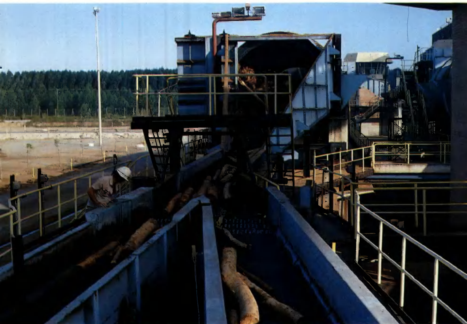
Projetado pela Divisão Jeffrey, da Dresser, este transportador de correia para toras com saída dupla foi instalado na Aracruz.
