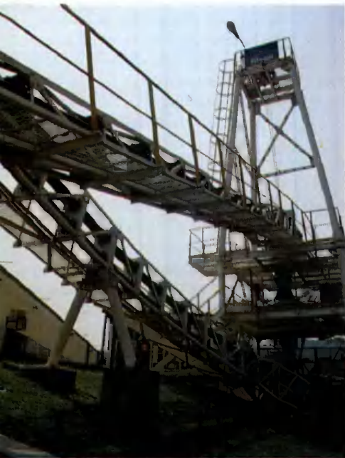
Projetado pela Divisão Jeffrey, da Dresser, este transportador de correia para toras com saída dupla foi instalado na Aracruz.
