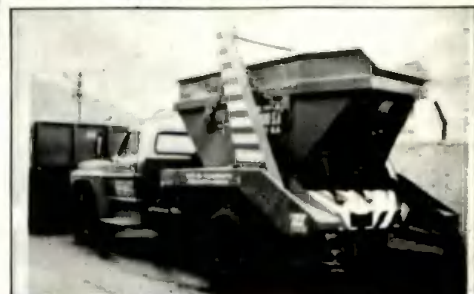
Modelo com capacidade para até 9 Tons. e que opera recipientes até 8,5 m 3 . Sapatas Hidráulicas articuláveis IND. DE PAPÉIS SANTO AMARO - Santo Amaro - BA
