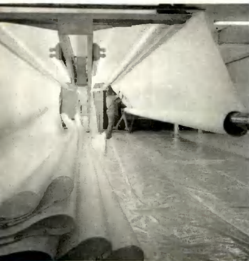
Técnicos especializados fazem uma rigorosa inspeção nas telas e feltros
