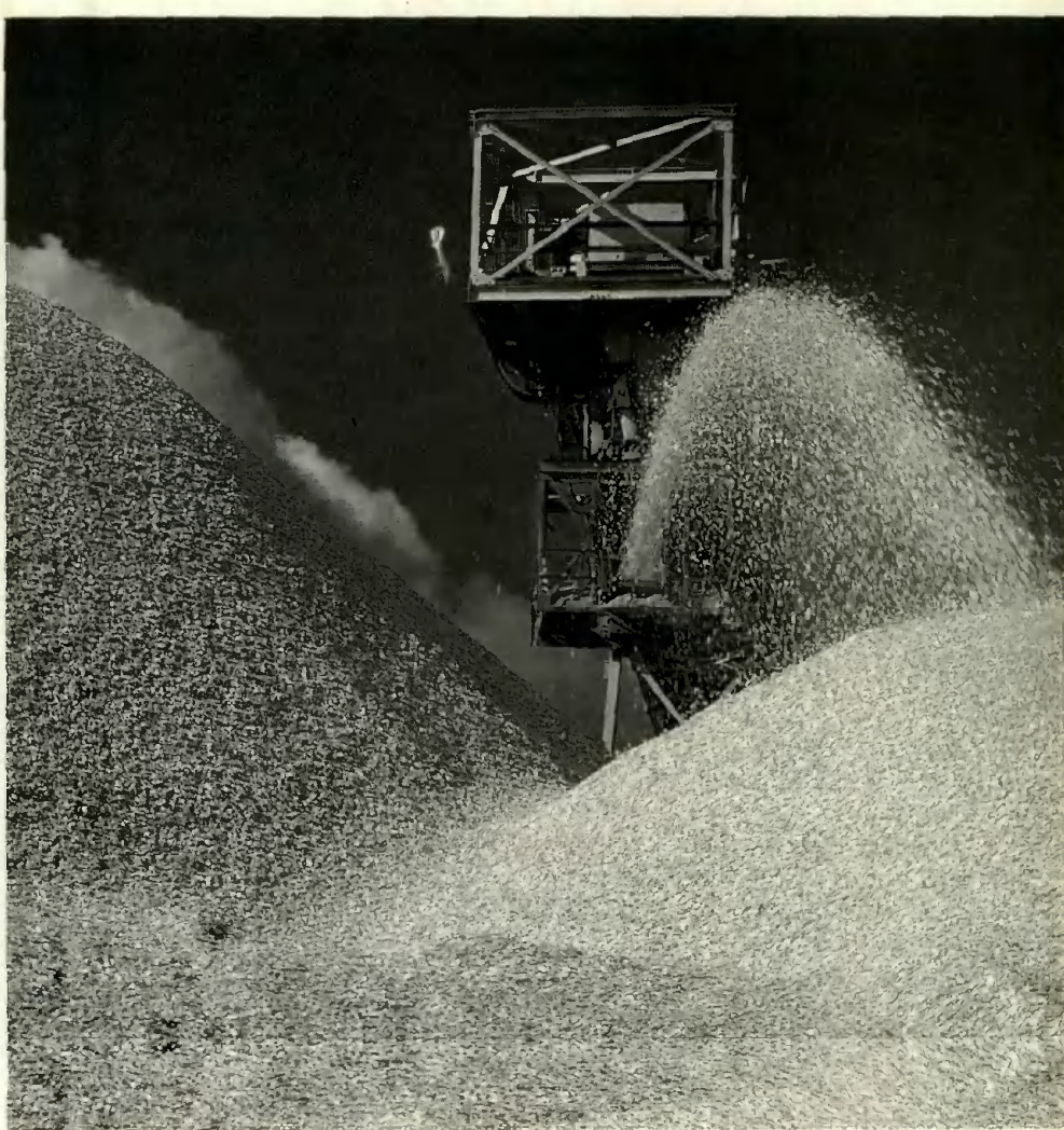
Daqui, o cavaco é levado para cozimento em oito digestores de 207 m³ cada um
