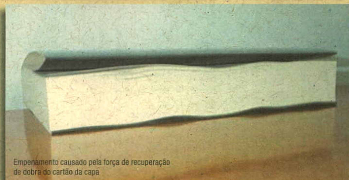
Deformação do miolo do livro devido ao sentido das fibras estar perpendicular à lombada
