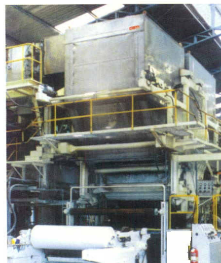
Capota Yankee, da CBTI, para secagem de papel tissue
