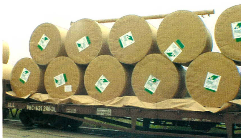
A permeabilidade das lonas propicia infiltração de água, molhando as bobinas
