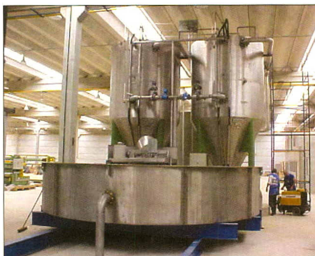
O decantador, como este fabricado pela Baker Hughes, é um dos equipamentos utilizados durante o tratamento primário
