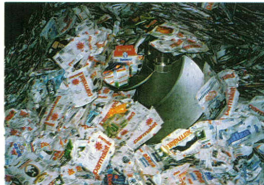
No hidrapulper, são separados os diferentes materiais que compõem a embalagem longa vida
