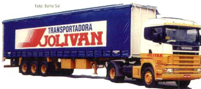
Caminhão sider agiliza operação de carregamento e descarregamento de bobinas
