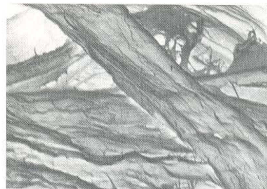
Fibras de celulose branqueada de Eucalyptus urophylla refinadas a 30°SR em refinador Valley beater, notando-se a hidratação das paredes e a fibrilação. (Prof. Pedro Kiyohara, microscópio eletrônico de varredura do Instituto de Física da Universidade de São Paulo).
