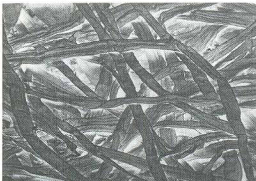
Fibras de celulose branqueada de Eucalyptus urophylla sem refinação. (Prof. Pedro Kiyohara, microscópio eletrônico de varredura do Instituto de Física da Universidade de São Paulo).
