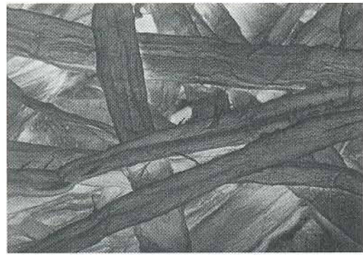
Fibras de celulose branqueada de Eucalyptus urophylla sem refinação. (Prof. Pedro Kiyohara, microscópio eletrônico de varredura do Instituto de Física da Universidade de São Paulo).
