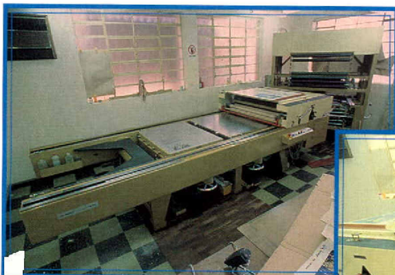
Moderno Prelo Automático de Provas com tiragem automática.
