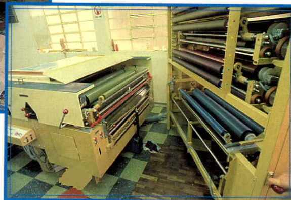
Moderno Prelo Automático de Provas com tiragem automática.
