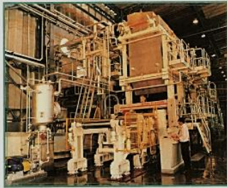
Máquina tissue piloto - VTM - construída exclusivamente para pesquisa e desenvolvimento
