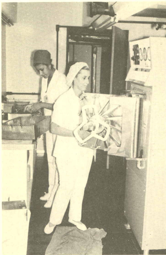
O Controle de infecções inicia-se no setor de materiais. Nesta autoclave é realizada a esterilização.
